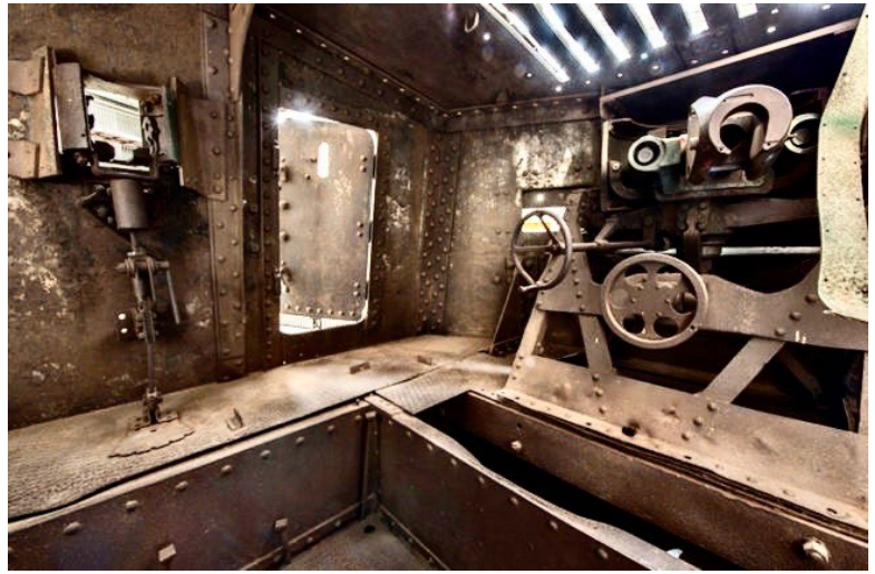
Vue de l'intérieur de l'A7V : on y voit l'emplacement du canon et ses deux manettes de commande. l'emplacement d'une mitrailleuse MG 08 et la porte d'accès dans le char.
