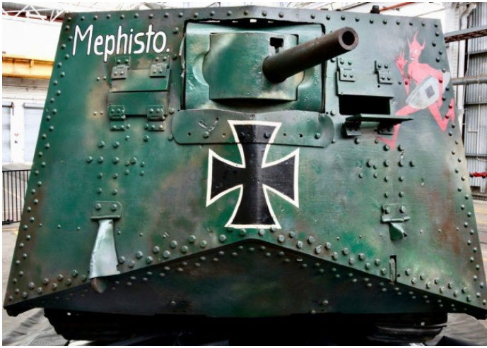
Le char Mephisto montrant son canon de 57 mm et 2 de ses 6 mitrailleuses MG 08 de 7,92 mm.
